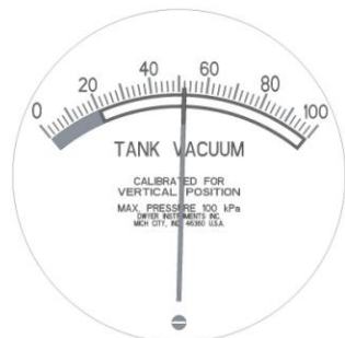
Εικόνα 13) Δείκτης κενού δεξαμενής με ένδειξη στην αποδεκτή περιοχή λειτουργίας και ρυθμιστική βίδα στο κάτω μέρος του δείκτη
