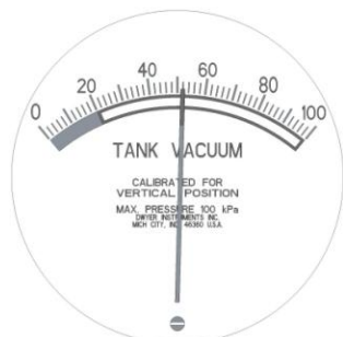
Joonis 13) Lubatud töövahemikus asuva näidikuga ja mõõdiku allosas asuva reguleerkruviga paagi vaakumi mõõdik
