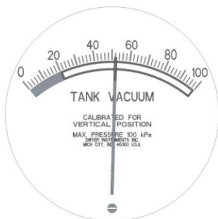
Figura 13) Vuotometro del serbatoio con indicatore nell'intervallo di funzionamento accettabile e vite di regolazione nella parte inferiore del dispositivo
