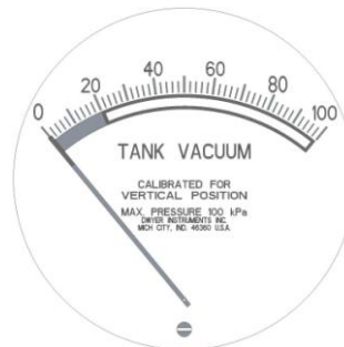
Rysunek 2) Wskaźnik podciśnienia w zbiorniku wskazujący zero oraz śruba regulacyjna w dolnej części wskaźnika
