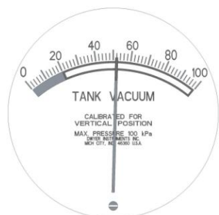
Figure 13) Vacuomètre du réservoir avec aiguille dans la zone de fonctionnement admissible et vis de réglage dans la partie inférieure du vacuomètre
