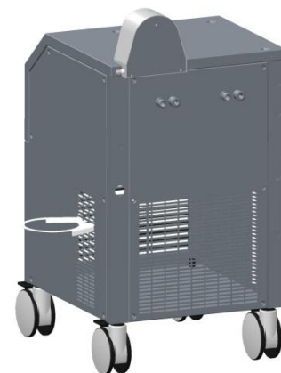
Figura 4) Supporto di montaggio installato sul pannello destro.
