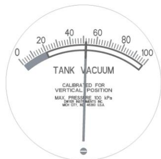
Abbildung 13) Messanzeige für Tankvakuum im zulässigen Betriebsbereich und Stellschraube im unteren Teil der Anzeige
