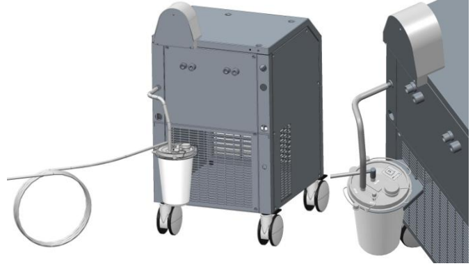
Şekil 10) Kapağın arka paneldeki emme kabı tutucuya takılmış olduğu kap
