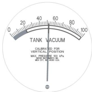
Kuva 13) Säiliön alipainemittarin osoitin hyväksyttävällä käyttöalueella ja mittarin alaosassa oleva säätöruuvi
