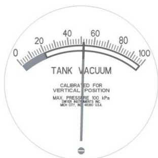
13. attēls) Tvertnes vakuuma mērierīce ar indikatora rādījumu pieļaujamā darba diapazonā un regulēšanas skrūvi mērierīces apakšā
