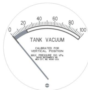
Figure 2) Vacuomètre du réservoir avec l'aiguille sur 0 et vis de réglage dans la partie inférieure du vacuomètre
