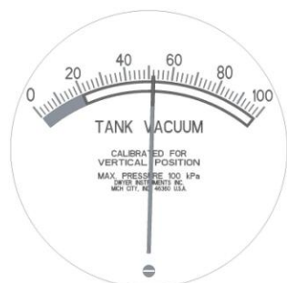
Figura 13) Calibrador de vacío del tanque con indicador en el área aceptable de funcionamiento y tornillo de ajuste en la parte inferior del calibrador
