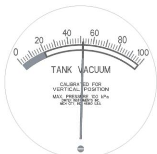
Rysunek 13) Wskaźnik podciśnienia w zbiorniku wskazujący wartość w dopuszczalnym zakresie roboczym oraz śruba regulacyjna w dolnej części wskaźnika
