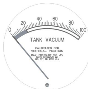
Figura 2) Indicatorul de măsurare a vidului din rezervor cu punctul zero și șurubul de reglare în partea de jos a aparatului de măsură
