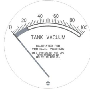
Figur 2) Tankvakuummåler med nullpunkt og justeringssskruen i den nederste delen av måleren
