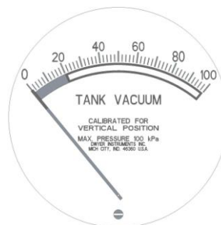
Kuva 2) Säiliön alipainemittari nollopisteessä ja mittarin alaosassa oleva säätöruuvi
