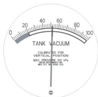
Фигура 13) Прибор за измерване на вакуум в резервоара с индикатор в приемлив работен диапазон и винт за настройка в близост до долния край на уреда
