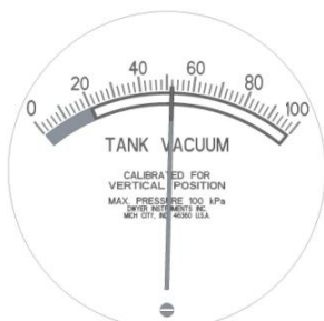
Figuur 13) Tankvacuümmeter met wijzernaald in het acceptabele werkgebied en stelschroef aan de onderkant van de meter
