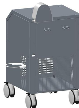
Figure 4) Support de montage posé sur le panneau droit.
