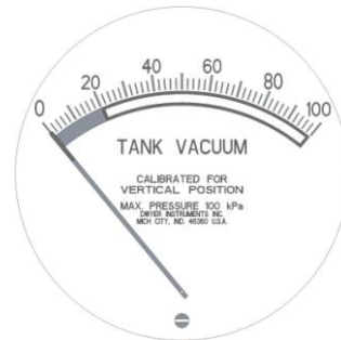
Joonis 2) Nullasendis paagi vaakumi mõõdik ja mõõdiku allosas asuv reguleerkrui
