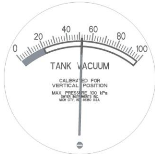
Şekil 13) Göstergenin kabul edilebilir çalışma alanında olduğu Tank Vakum göstergesi ve göstergenin altındaki ayar vidası
