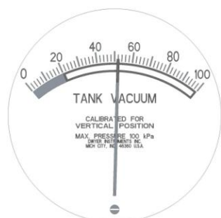
Figur 13) Tankens vakuummåler med indikator i det akseptable driftområdet og justeringssskruen i den nederste delen av måleren
