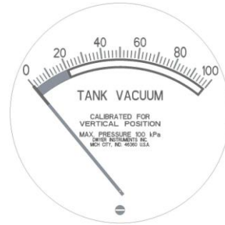
Figura 2) Calibrador de vacío del tanque con punto cero y tornillo de ajuste en la parte inferior del calibrador
