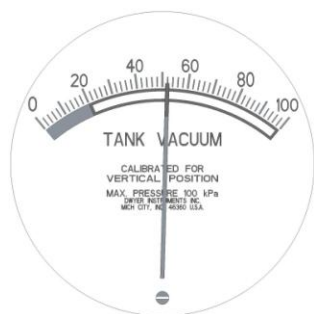
Bild 13) Tankens vakuummätare med visare i acceptabelt driftområde och justerskruv i mätarens nedre del
