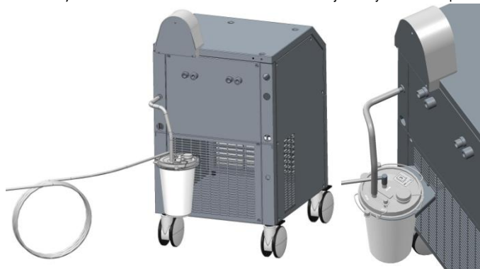
Obrázok 10) Nádoba s vekom nasadená na držiak odsávacej nádoby na zadnom paneli
