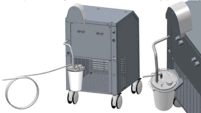
10. attēls) Tvertne ar vāciņu, kas ievietota sūkšanas tvertnes turētājā pie aizmugurējā paneļa
