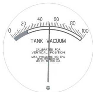
Figura 13) Medidor de vácuo do reservatório com o indicador na área aceitável de funcionamento e o parafuso de ajuste na secção inferior do medidor
