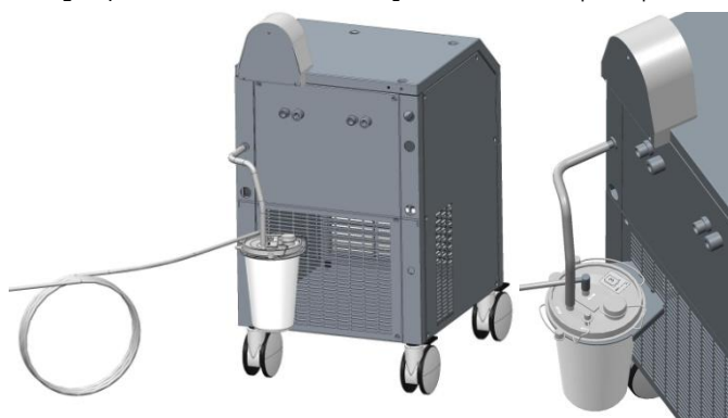
Figur 10) Beholder med lokk føres inn i sugebeholderens holder på bakpanelet
