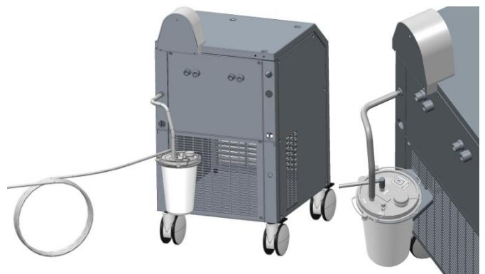
Figura 10) Recipiente con tapa introducido en el soporte del recipiente de succión en el panel posterior
