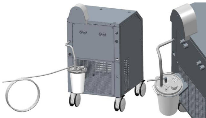
Figura 10) Recipiente com a tampa instalada, inserido no respetivo suporte no painel traseiro
