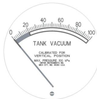
Obr. 2) Měřidlo podtlaku v zásobníku s nulovým bodem a stavěcím šroubem ve spodní části měřidla
