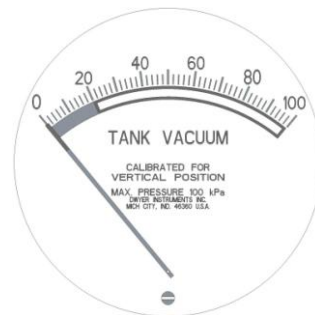
Abbildung 2) Messanzeige für Tankvakuum mit Nullpunkt und Stellschraube im unteren Bereich
