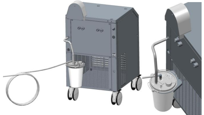
Εικόνα 10) Δοχείο με το καπάκι, τοποθετημένο στο στήριγμα του δοχείου αναρρόφησης στην πίσω πλευρά
