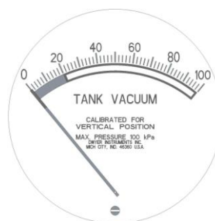
Figura 2) Medidor de vácuo do reservatório com o ponto zero e parafuso de ajuste na secção inferior do medidor
