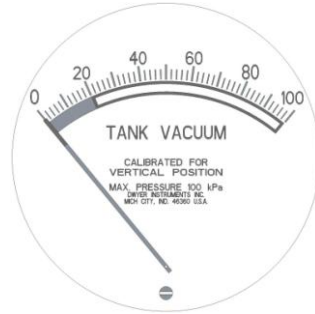
Фигура 2) Прибор за измерване на вакуум в резервоара с нулева точка и винт за настройка в близост до долния край на уреда
