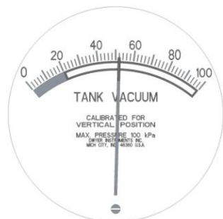
Obr. 13) Měřidlo podtlaku v zásobníku s ukazatelem v přípustném provozním rozsahu a se stavěcím šroubem ve spodní části měřidla
