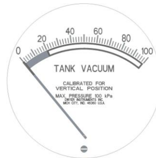
Figur 2) Tankens vakuummåler med nulpunkt og justeringsskruen i bunden af måleren
