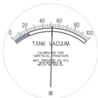
Slika 13) Merilnik vakuumu v rezervoarju s kazalcem v območju, ki je sprejemljivo za delovanje sistema, in prilagoditveni vijak na spodnjem delu merilnika
