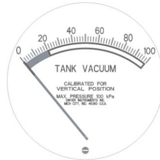
Figuur 2) Tankvacuümmeter met nulpunt en stelschroef aan de onderkant van de meter
