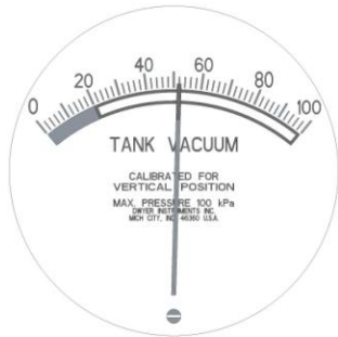
13. ábra) Tartály vákuummérője a megfelelő működési tartományban és a mérőműszer alsó részén található beállítócsavar
