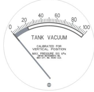
Şekil 2) Tank Vakum göstergesi ve göstergenin altındaki sıfır noktasıyla ayar vidası
